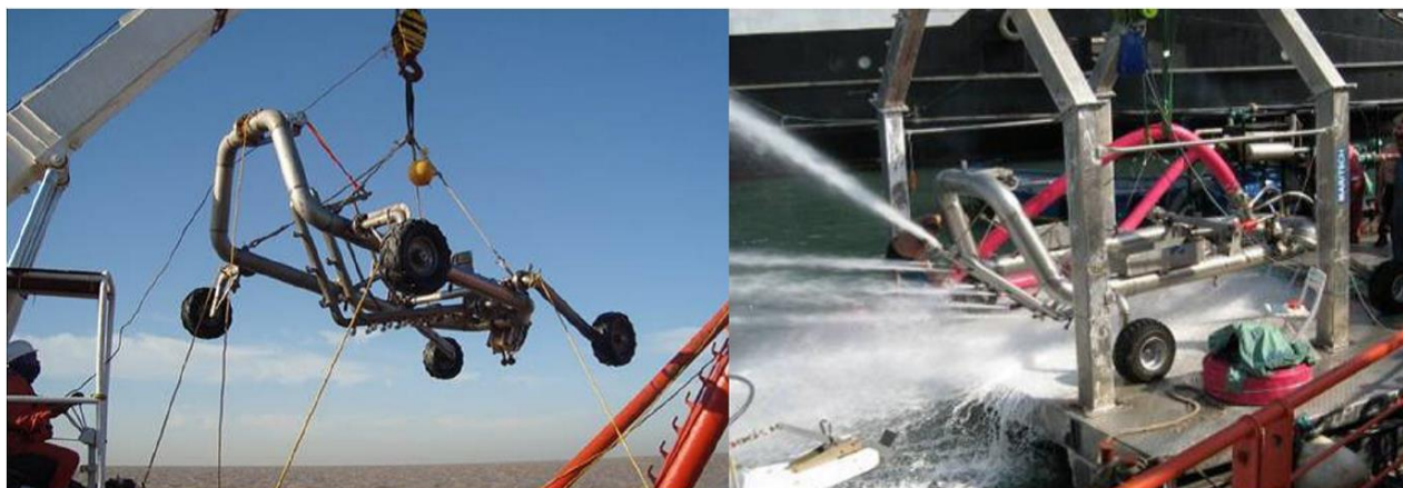
Figure 34 : Trencher de type « jet sledge » permettant l'ensouillage des câbles (Orange Marine)
