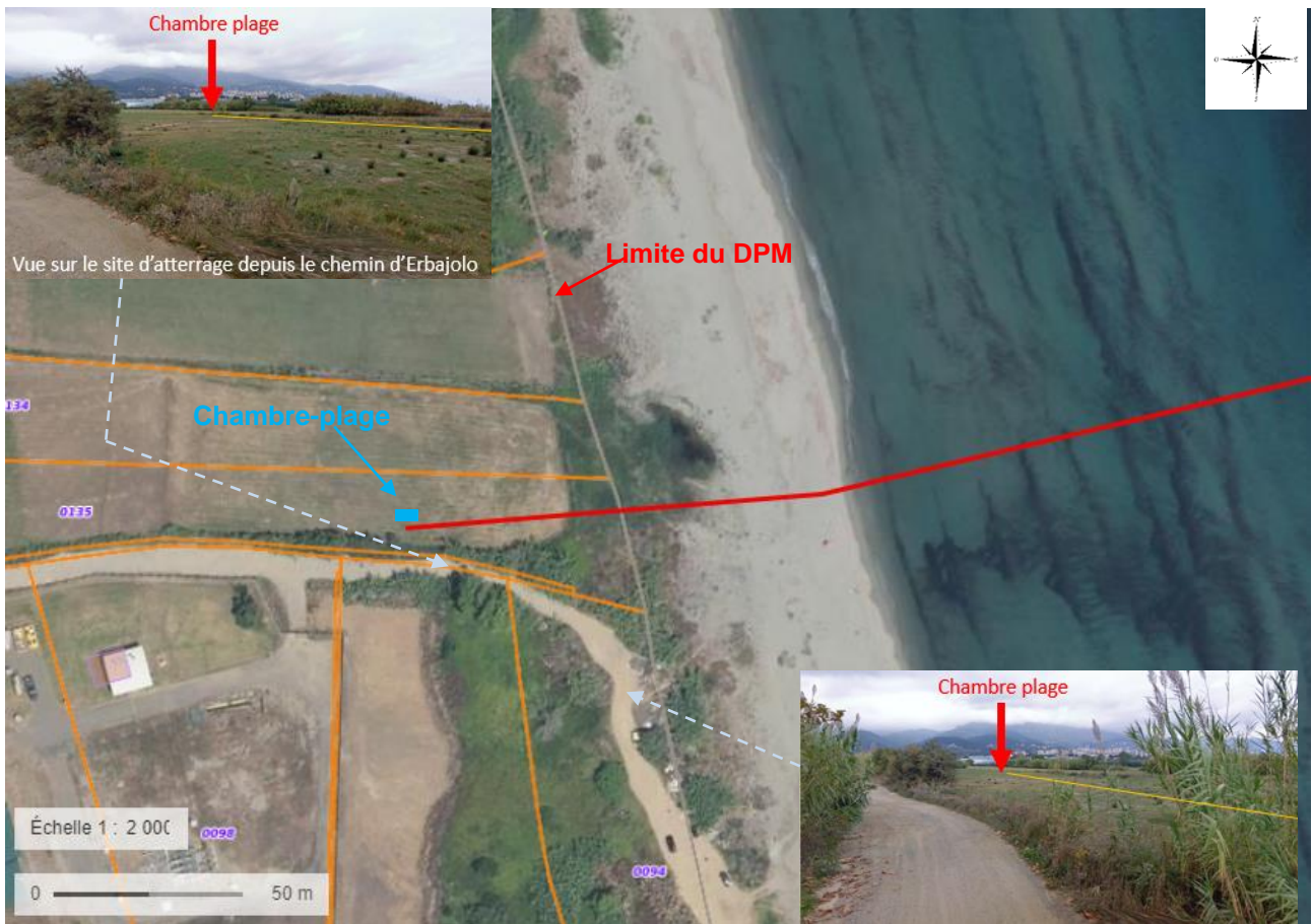
Figure 3 : Parcours du câble Bluemed depuis la limite plage/mer jusqu'à la chambre plage située hors du DPM
