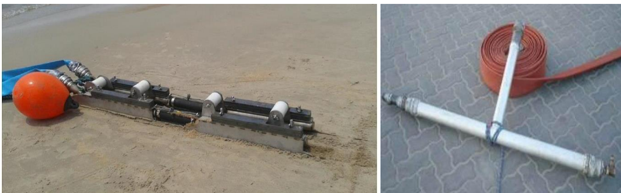
Figure 35 : « Jet sledge » de type WORM pour les eaux très peu profondes (à gauche), lance à eau d'ensouillage (à droite) (source : Orange Marine)
