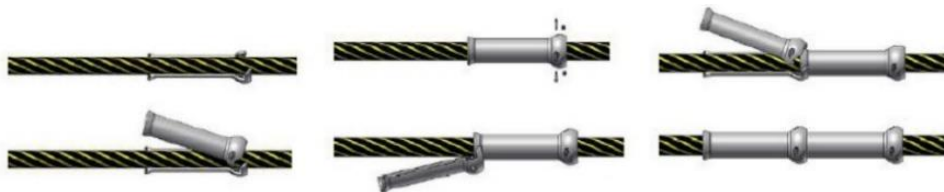
Figure 32 : Procédure d'installation des coques de protection sur le câble
